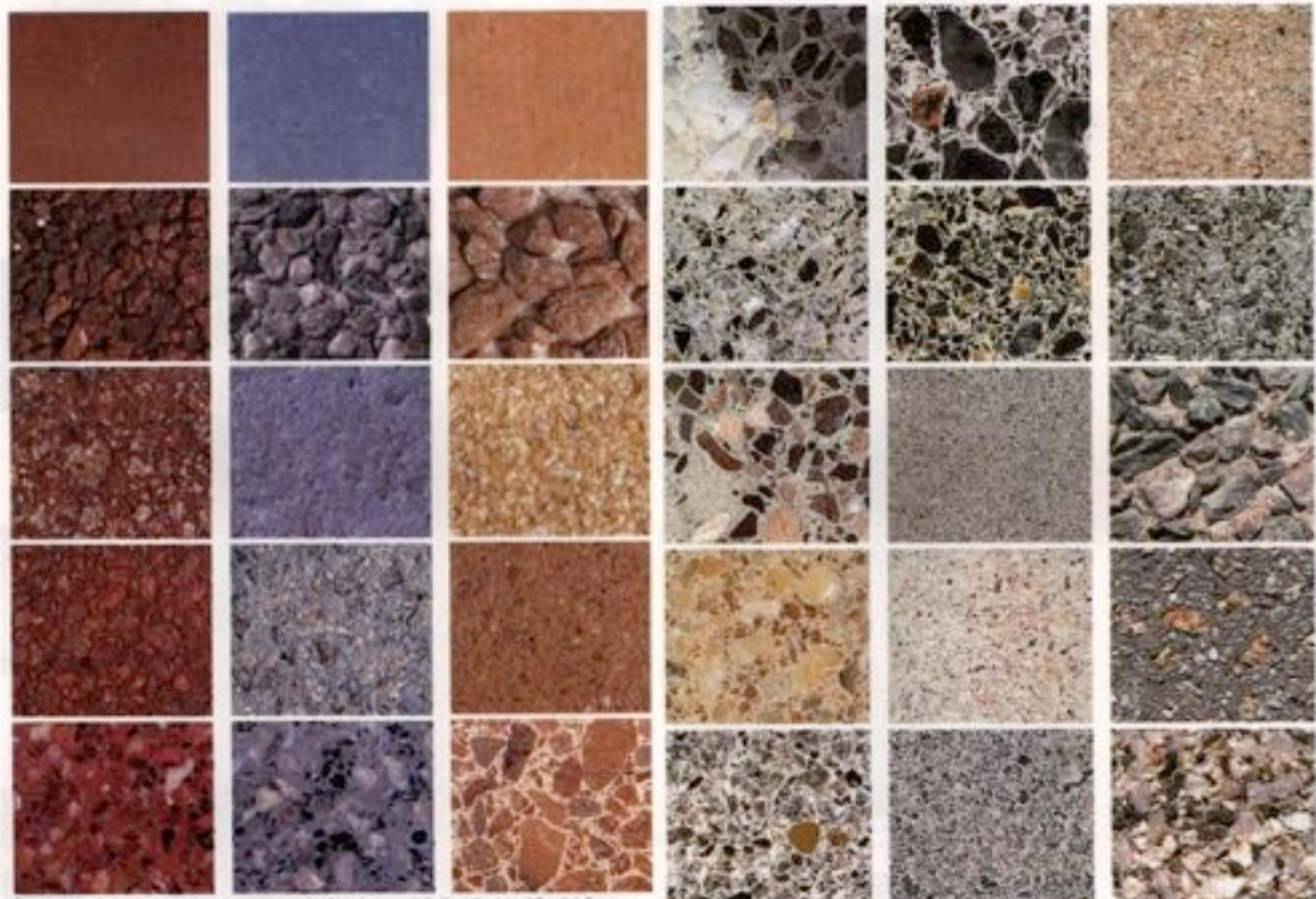
Echelle d'aspect des bétons de granulats colorés. De haut en bas: béton lisse, retenu (gris), acide, gris, noir. Extrait de l'ouvrage
